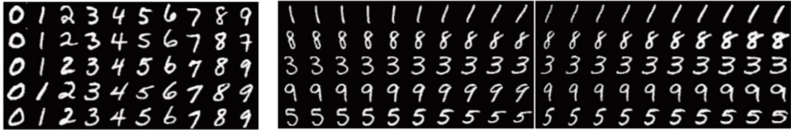
그림 10-11 InfoGAN의 해석 가능한 모양 특징(왼쪽 c_1 : 부류, 중간 c_2 : 획 기울음, 오른쪽 c_3 : 획 두께)[Chen2016]
