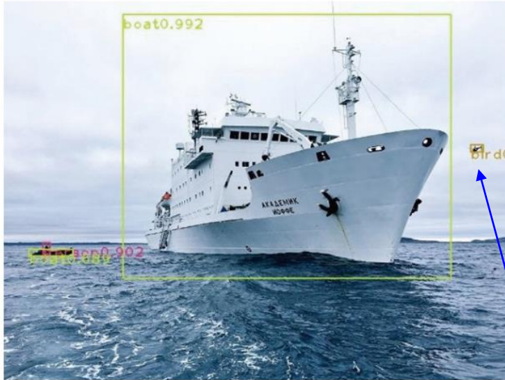
그림 6-21 YOLOv3를 이용한 물체 검출과 분류
